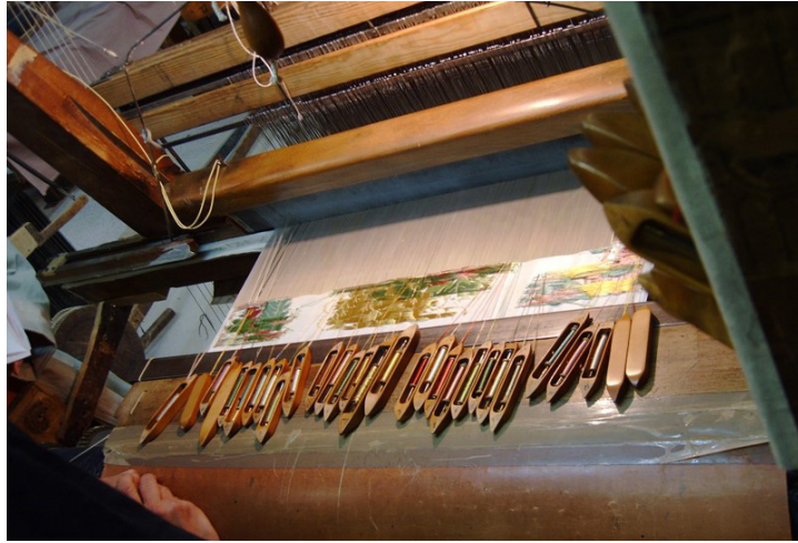
Abb. 12: Broschierwebstuhl. Der Stoff wird mit der Rückseite nach oben gewebt, darauf liegen die Broschierschiffchen, die partiell eingeschossen werden. Tassinari Chatel, Lyon © Ullermann
